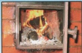
Своевременно проверяйте исправность печи и дымохода (удаляйте сажу, заделывайте трещины, белите дымовую трубу на чердаке и выше кровли).
